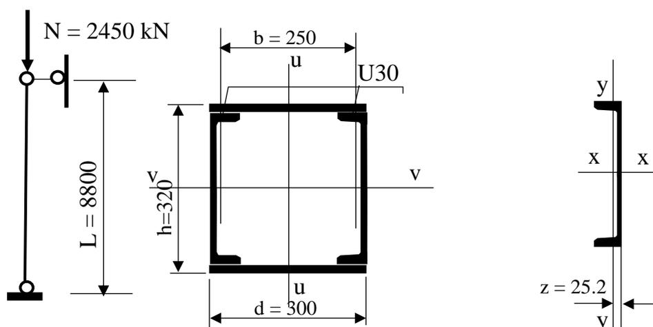
Số liệu: Thép U30 có  $A = 40.5 \text{ cm}^2$ ,  $J_x = 5810 \text{ cm}^4$ ,  $J_y = 327 \text{ cm}^4$ ,  $W_x = 387 \text{ cm}^3$ ,  $W_y = 43.6 \text{ cm}^3$ ,  $z = 2.52 \text{ cm}$ . khoảng cách giữa hai tim thép U bằng 25 cm.
